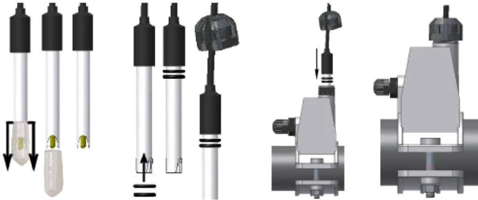
Fig. 3- Montaje de la sonda en el porta sonda
