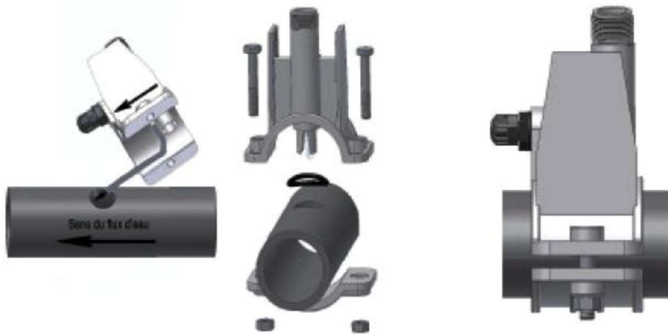
Fig. 2- Montaje porta sonda
